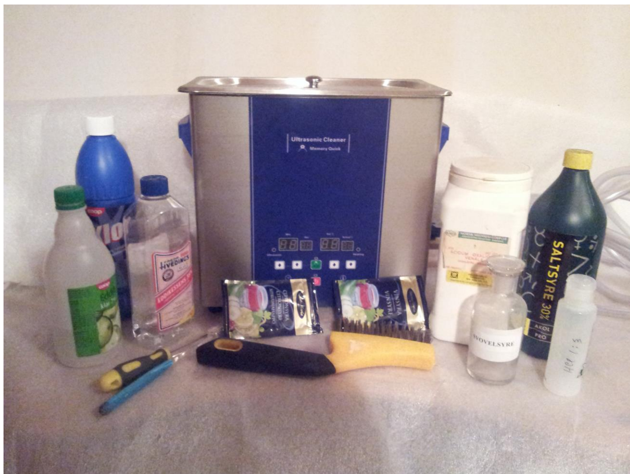
Diverse utstyr. Ultralydbeholderen ser du midt på fotoet. 30 % saltsyre kjøpes normalt på et byggevarehus, ikke et apotek. Foto Birger Førstund.
